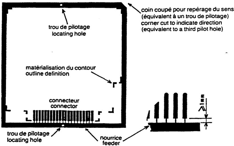
fig. 11 nourrice et pilotage
