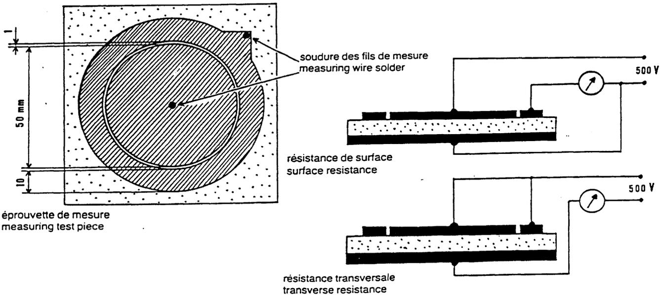
fig.3 mesure des résistances
