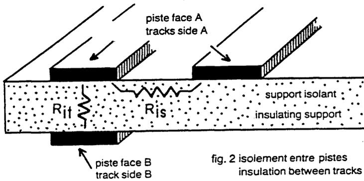
fig. 2 isolement entre pistes
