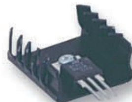
Type de boîtier: TO220 - Résistance thermique: 14.2°C/W
